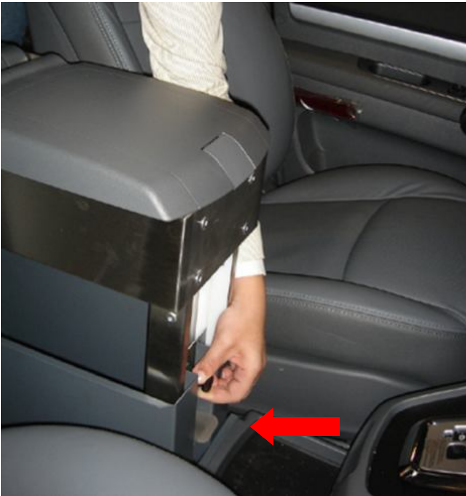
10. For at sænke køkkenet på plads, trækkes der ud i låstangen i hver side og køkkenet sænkes på plads.
