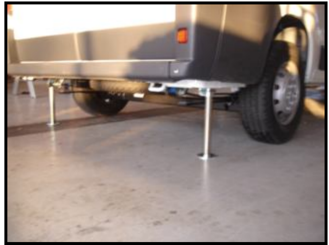
Hydrauliske støtteben forhindrer sammen-senkning ved pålæsning / aflæsning.
