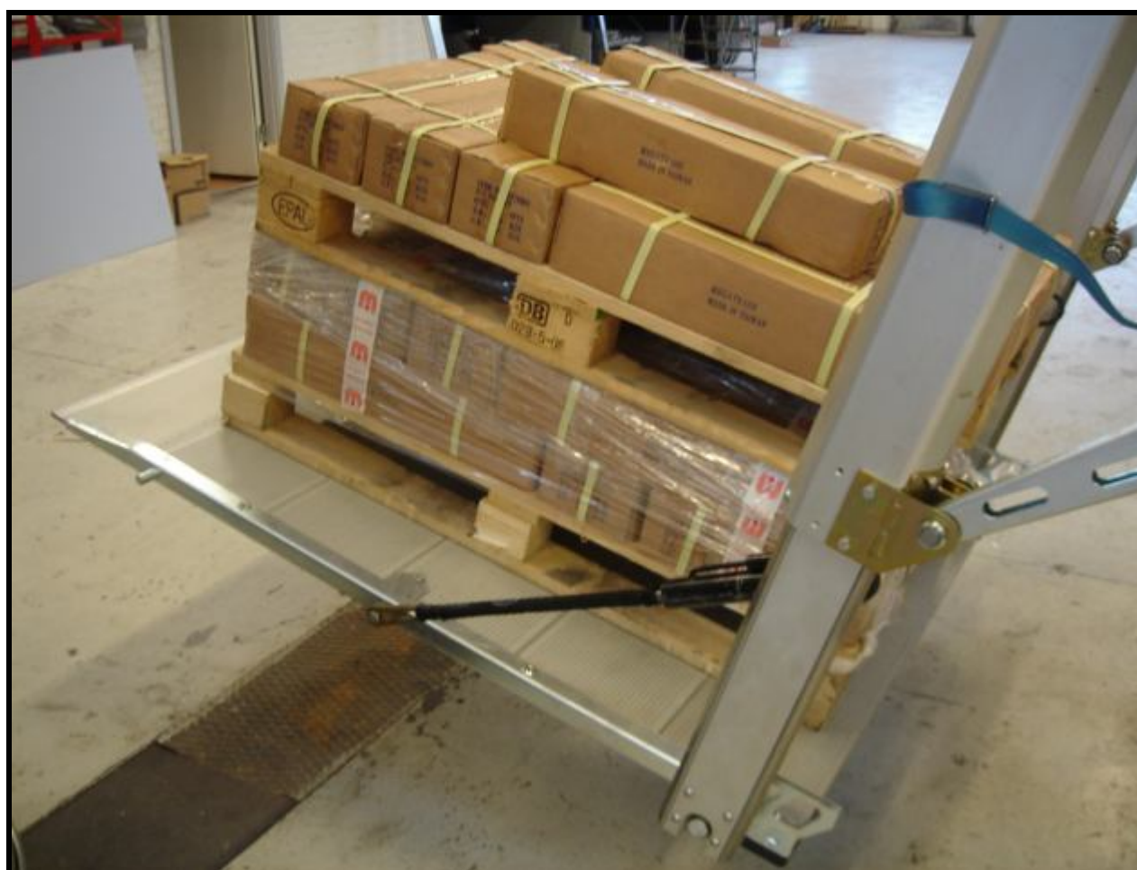
Hydraulisk vip af liftplade (+ 420 mm. / - 100 mm.)
